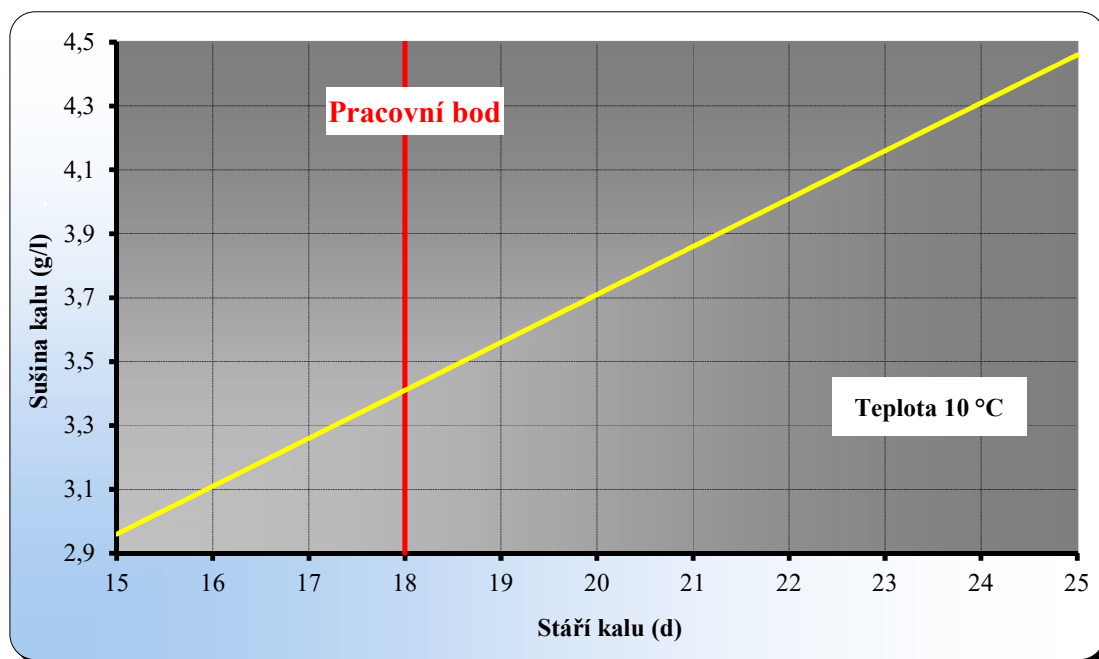
Obr. 6: Výpočet závislosti koncentrace sušiny kalu na stáří kalu pro ČOV Lipová.
